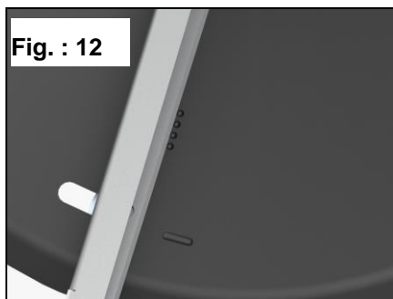
Aube d'épandage I sur point 4
