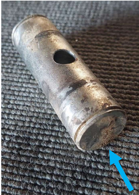
Abbildung 27: alter Bolzen ohne Innengewinde
