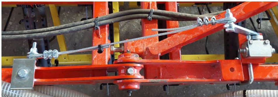
Abbildung 13: Hubbegrenzer und Blechprofil mit Seil verbunden
