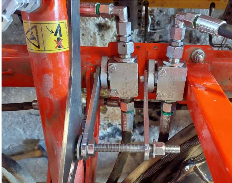
Abbildung 30: Steuergestänge mit den Hubbegrenzern verbunden
