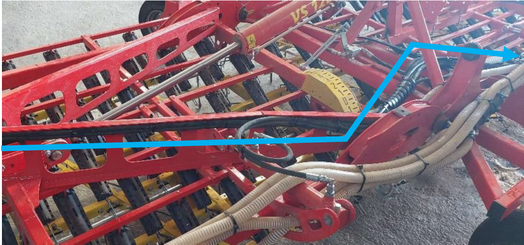
Abbildung 17: Schlauchverlegung von Hubbegrenzer zu Mengenteiler 2
