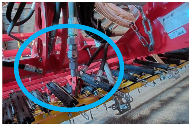
Abbildung 20: Öffnung der Verschraubungen
