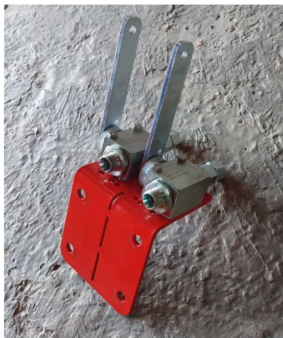
Abbildung 22: Hubbegrenzerbefestigung auf Halteblech 2
