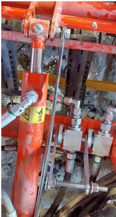
Abbildung 31: fertig montiertes Steuergestänge
