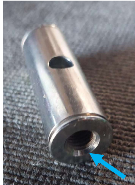
Abbildung 28: neuer Bolzen mit Innengewinde
