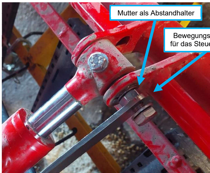
Abbildung 29: Steuergestänge am Bolzen befestigt
