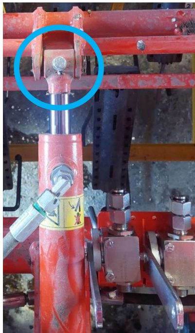
Abbildung 25: Bolzen mit Sicherungsschraube
