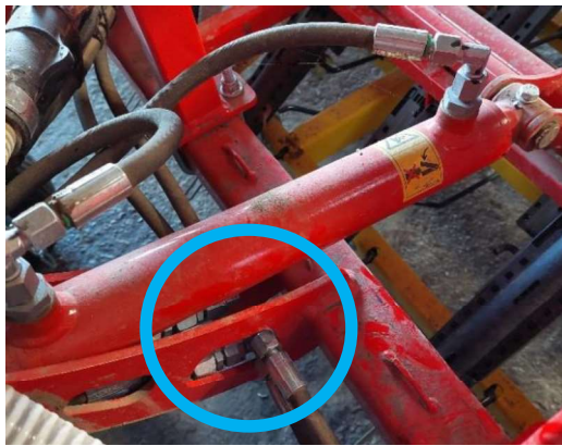
Abbildung 19: Ort der Winkelverschraubungen
